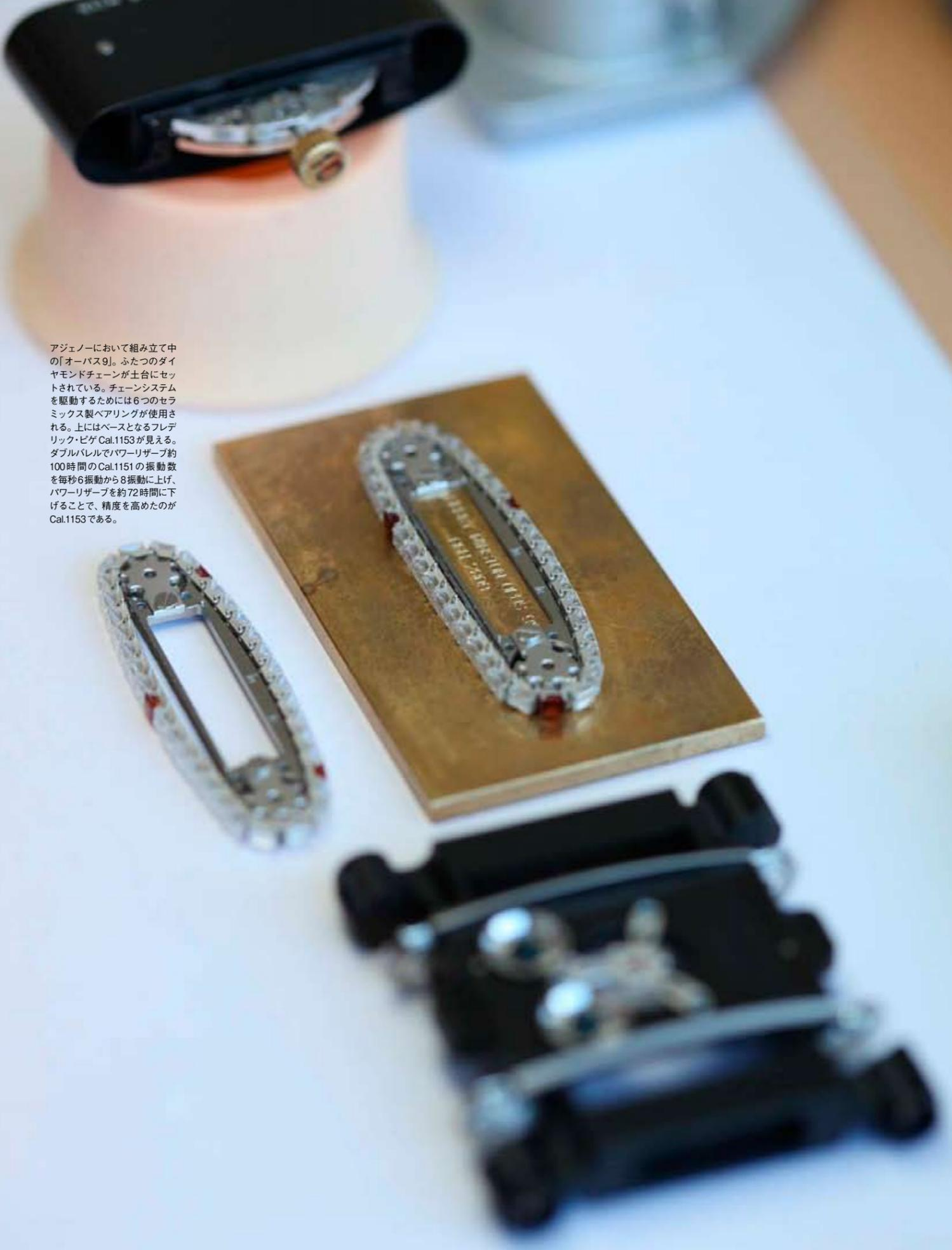
アジェノーにおいて組み立て中の「オーパス9」。ふたつのダイヤモンドチェーンが土台にセットされている。チェーンシステムを駆動するためには6つのセラミック製ベアリングが使用される。上にはベースとなるフレデリック・ピゲ Cal.1153が見える。ダブルバレルでパワーリザーブ約100時間の Cal.1151の振動数を毎秒6振動から8振動に上げ、パワーリザーブを約72時間に下げること、精度を高めたのが Cal.1153である。
